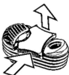
Bij het reinigen van Deksel Koeleenheid in Isopropylacohol, moet u de Dekselvergrendeling verwijderen.
