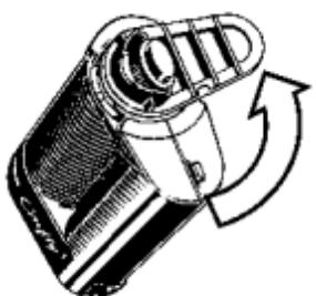
Svitare il fondo dell'Unità di Raffreddamento dal Vaporizzatore compiendo una rotazione di 90° in senso antiorario.
