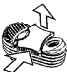
Bei Reinigung des Kühleinheitdeckels in Isopropylalkohol, den Deckelriegel entfernen.
