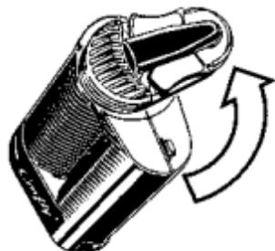
Svitare l'Unità di Raffreddamento dal Vaporizzatore compiendo una rotazione di 90° in senso antiorario.
