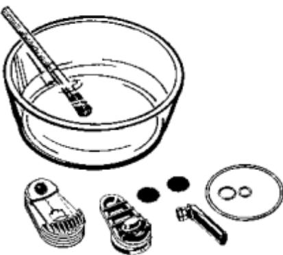
Immergere tutti i componenti dell'Unità di Raffreddamento in acqua di lavaggio calda.
