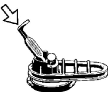
Sieb mit Füllkammerwerkzeug von oben nach unten aus Kühleinheitboden herausdrücken.
