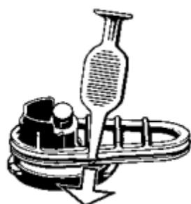
Haal de grote Bodemaf-dichtring met Vulkamer-hulpmiddel uit de uitsparing in de groef. Verwijder de kleine Bodemafdichtring.
