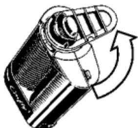
Kühleinheitboden durch eine 90° Drehung entgegen dem Uhrzeigersinn abschrauben.
