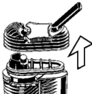
Trek het Deksel van de Koeleenheid van de Verdampert.
