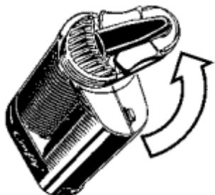
Kühleinheit durch eine 90° Drehung entgegen dem Uhrzeigersinn vom Verdampfer abschrauben.
