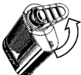
Desenrosque la Unidad de Enfriamiento del Vaporizador girando 90° en sentido contrario a las agujas del reloj.
