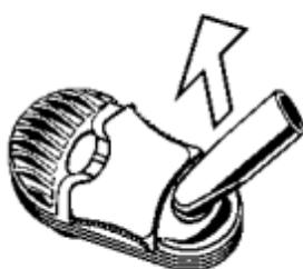
Extraiga la Boquilla moviéndola e inclinándola ligeramente de la tapa de la Unidad de Enfriamiento. Extraiga el Anillo de Sellado de Boquilla.
