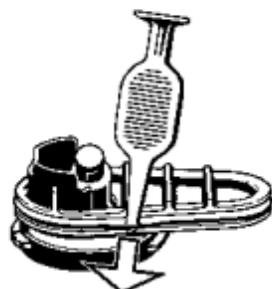
Levante el Anillo de Sellado de Fondo grande con la Herramienta del Depósito en la muesca de la ranura.
