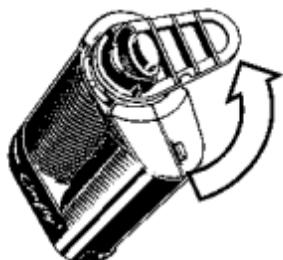
Schroef de Koeleenheid-bodem los van de Verdamer door hem 90° tegen de wijzers van de klok in te draaien.
