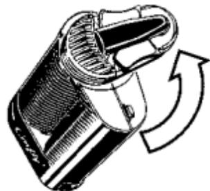
Schroef de Koeleenheid los van de Verdampert door hem 90° tegen de wijzers van de klok in te draaien.
