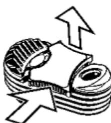
En caso de limpieza de la tapa de la Unidad de Enfriamiento en alcohol isopropílico, retire el cierre de la tapa levantando en un lateral.
