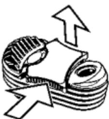
Pour nettoyer le couvercle de l'Unité de Refroidissement avec de l'alcool isopropylique, démonter le Verrou de Couvercle en le soulevant d'un côté.
