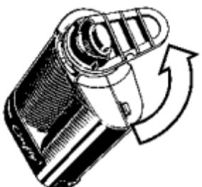
Démonter la base de l'Unité de Refroidissement du Vaporisateur en le dévissant de 90° dans le sens inverse des aiguilles d'une montre.
