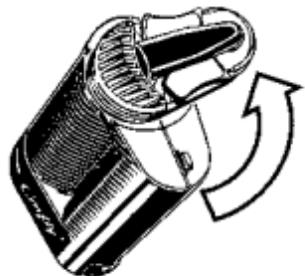
Démonter l'Unité de Refroidissement du Vaporisateur en la dévissant de 90° dans le sens inverse des aiguilles d'une montre.
