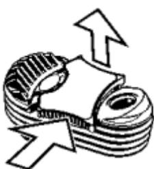
In caso di pulizia del coperchio dell'Unità di Raffreddamento nell'alcool isopropilico, smontare il chiavistello del coperchio sollevandolo da un lato.
