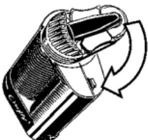
Kühleinheit durch eine 90° Drehung im Uhrzeigersinn auf den Verdampfer anschrauben.
