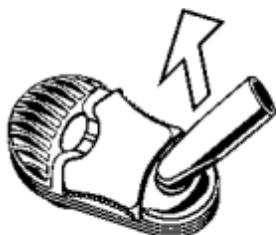
Trek het Mondstuk uit het Deksel van de Koeleenheid door licht heen en weer te kantelen.
