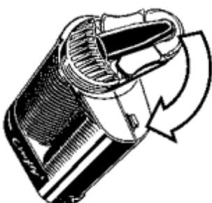
Avvitare l'Unità di Raffreddamento sul Vaporizzatore compiendo una rotazione di 90° in senso orario.
